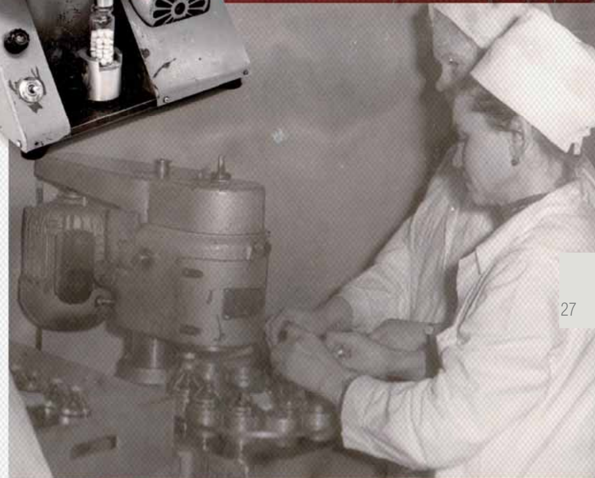
Эта счетно-фасовочная машина для упаковки препаратов бактериофагов была сконструирована сотрудниками завода в г. Горький (ныне Нижний Новгород)
